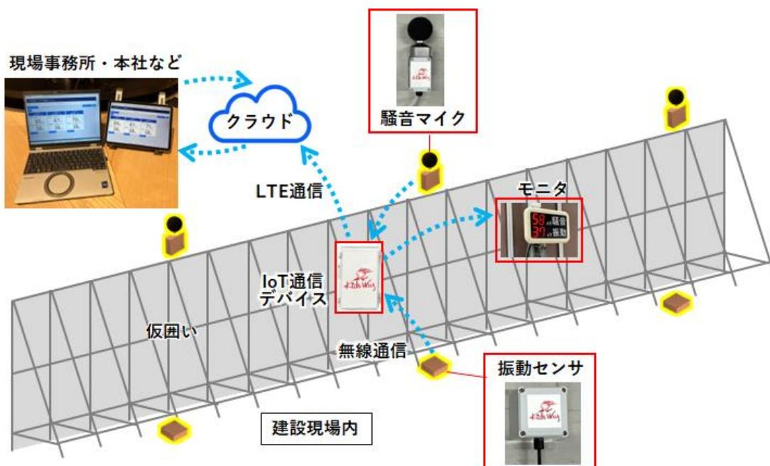
DECIBERY は、竹中工務店とアトムシステムが共同開発したデジタルデバイスによる騒音・振動計測機構とクラウド関連システムをベースに、キッズウェイが量産・在庫保有・レンタル展開を担うことで、建設現場へのスムーズな製品提供を可能としています。
